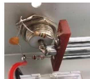
Detalles conexión L1, L3 lado RTX y conexión L1, L3 lado ANTENA
