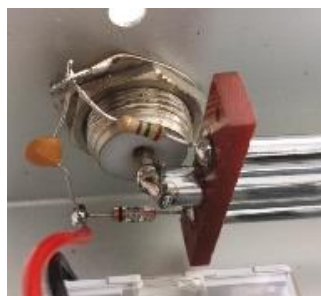
Detalles conexión L1, L3 lado RTX y conexión L1, L3 lado ANTENA
